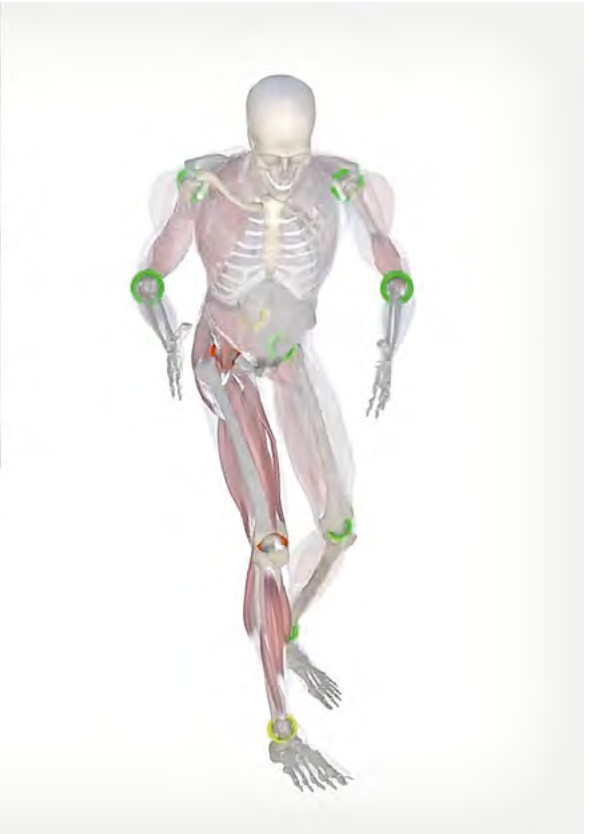
Abbildung 1: Belastungsanalyse eines Arbeitsplatzes mittels Computer-MyoGraphie (CMG). Links ein Originalbild beim Entladen eines Containers und rechts korrespondierend der entsprechende digitale Zwilling (der „Myonardo“) der Fachkraft. Muskeln, welche bei einer Bewegung unter Beanspruchung sind, werden sichtbar, nicht-beanspruchte Muskeln sind transparent. Mittels eines Ampelschemas wird die Höhe der Belastungen der Gelenke durch Kreise an den Gelenken direkt sichtbar gemacht.
